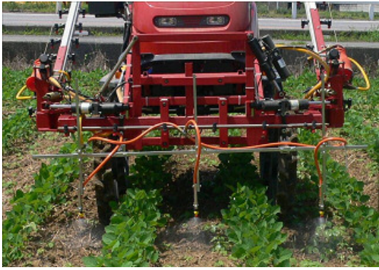
写真5 乗用管理機による畦間・株間処理の様子
