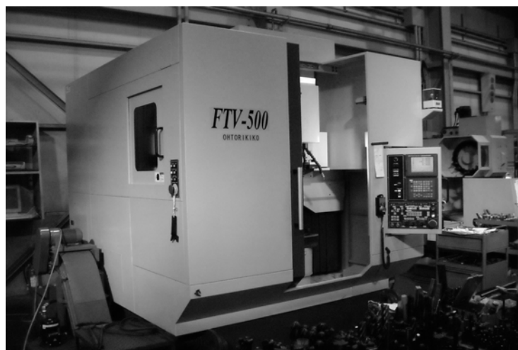
図 1 - 1 2 5 軸制御型マシニングセンタ
