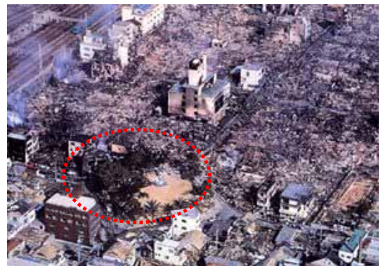
阪神・淡路大震災時に、緑が延焼を防止した。 ( 大園公園、兵庫県神戸市長田区 )
