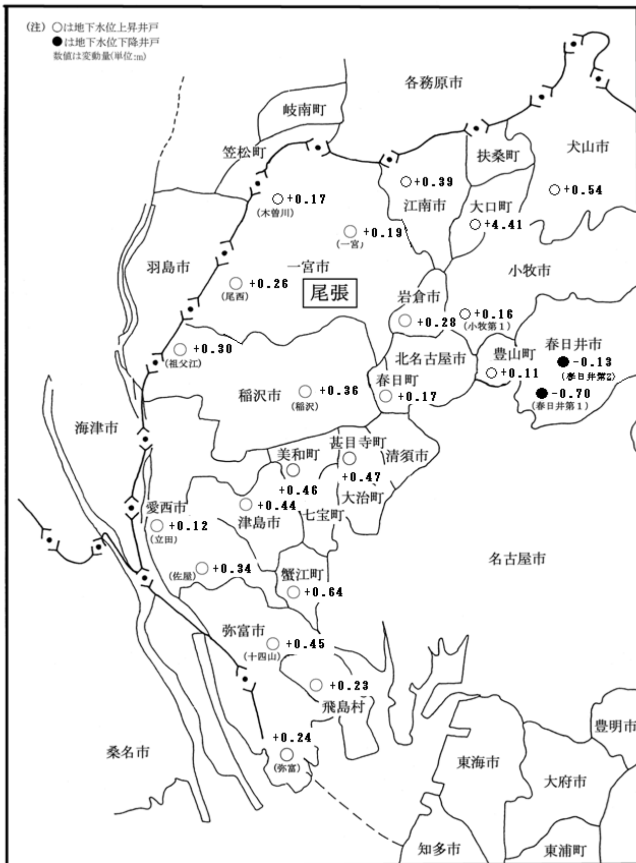
図-15 G3層の地下水位変動状況 (平成19年と20年の平均地下水位比較)
