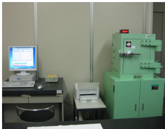
図4 上：Ge半導体測定装置機構図 下：当所に配備されたGe半導体測定装置
