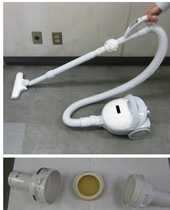
図 3 上 塵採取の方法 下 ダストサンプラー
