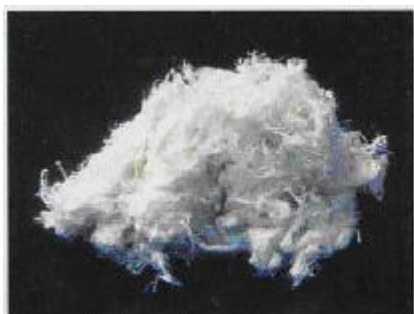
▲白石綿(クリソタイル)
