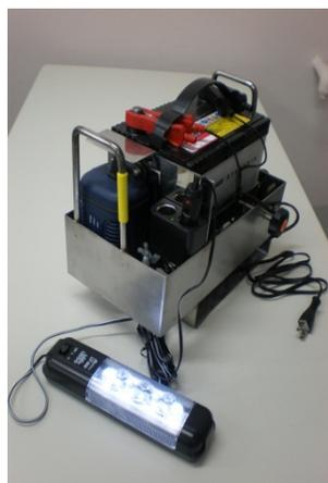
自動車のバッテリーを利用した人工呼吸器の補助電源
