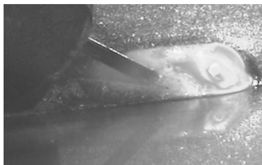
ハイスピードカメラによる「レーザ・アークハイブリッド溶接」の可視化
