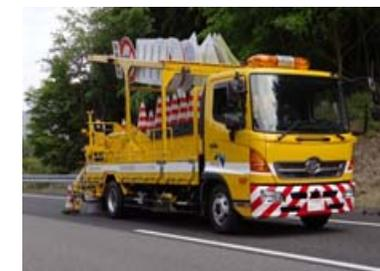
New! ラバーコーン設置・回収車
