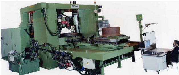
CNC全自動超大型ピストンリング内外径カム旋削機
