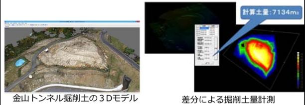
金山トンネル掘削土の3Dモデル
