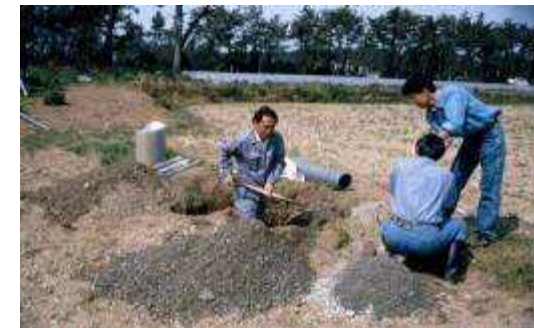
水田浄化機能調査用井戸の掘削
