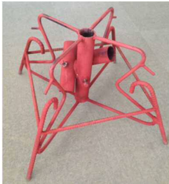
くくり罠補助具「からまる棒」 ※ 杭を3本打って固定する
