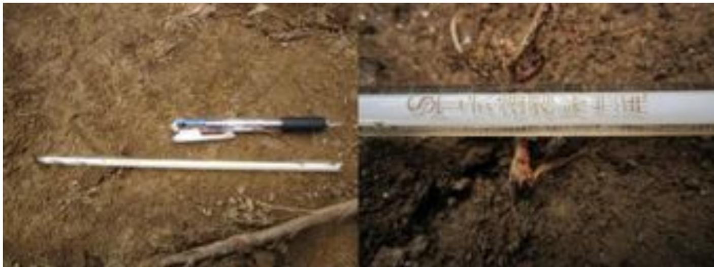
左：(写真3) 製炭用温度計(近代)
