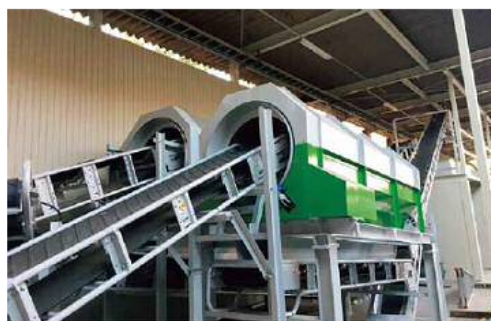
施設整備補助金を活用した 廃プラスチック等の混合廃棄物選別ライン
