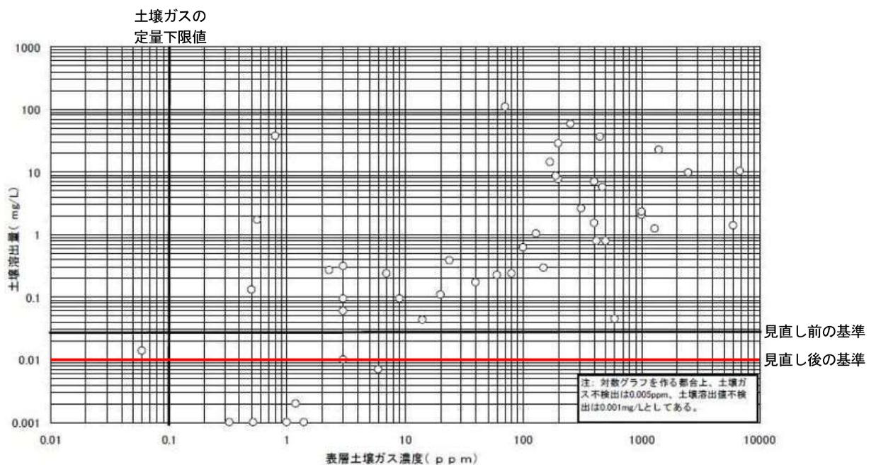
図 1 表層土壌ガス濃度と土壌溶出量の関係（トリクロロエチレン）
