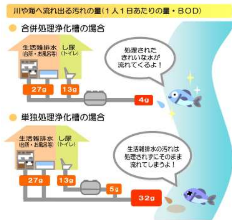
図 2-21 合併処理浄化槽と単独処理浄化槽の比較
