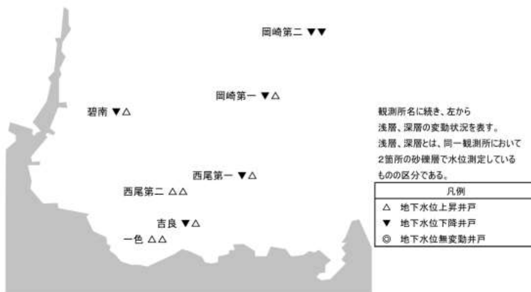
図 2-35 西三河地域における観測井の地下水位変動状況 (2018 年と 2019 年の平均地下水位比較)
