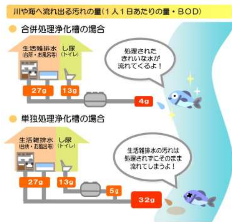
図 2-25 合併処理浄化槽と単独処理浄化槽の比較 図 2-26 発生源別にみた汚れの割合（愛知県の海域）
