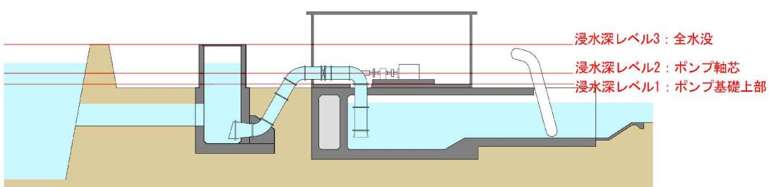
※排水機場によって、上記浸水深レベルが前後する場合がある。その場合も浸水深レベルが低いものから浸水深レベル1、浸水深レベル2、浸水深レベル3と設定をする。
