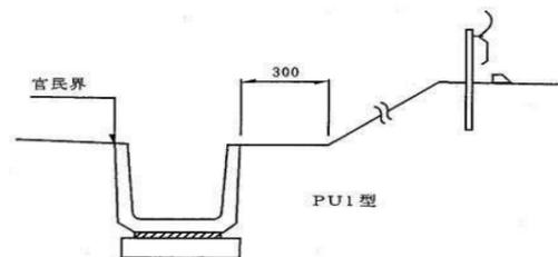
図 3.3 一般部の排水構造
