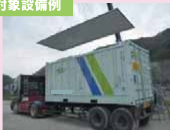
循環資源輸送容器（コンテナ）及び循環資源運搬設備（シャーシ）の例
