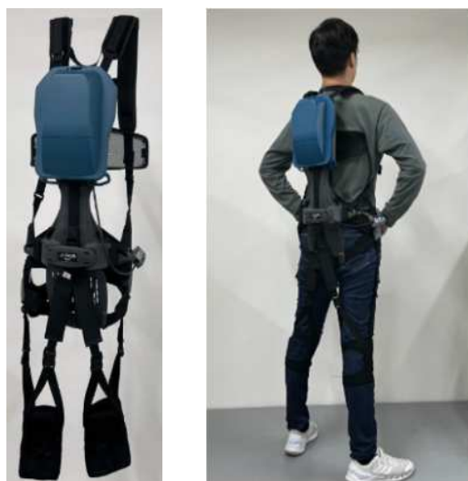
写真1 株式会社ジェイテクトが開発した農業用アシストスーツ (左：本体、右：着用時の後ろ姿)
