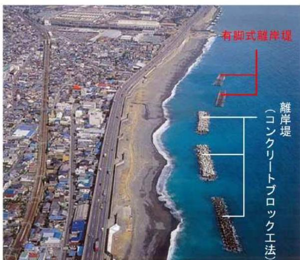
←従来のコンクリートブロック工法による離岸堤では、離岸堤の配置に応じてトンボロ状の地形が発達して、元々の汀線形状に対する歪みが大きく、不自然な形状となりやすい。
