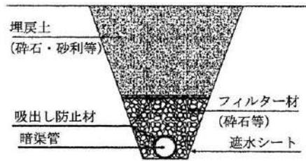
図 8-3 山腹暗渠 構造概念図
