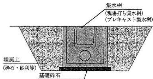
図 8-4 集水桝 構造概念図
