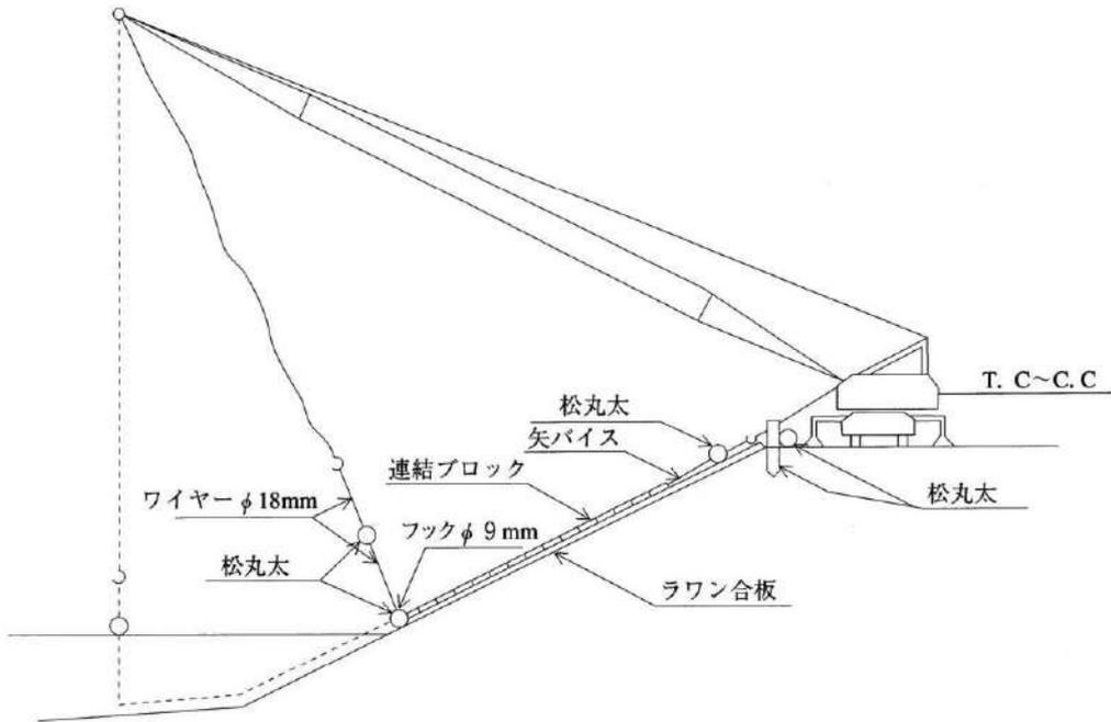
図 5-2 接続ブロック水中吊落し断面図
