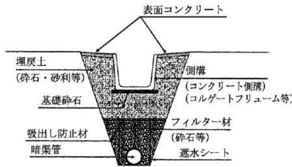
図 8-2 山腹明暗渠 構造概念図
