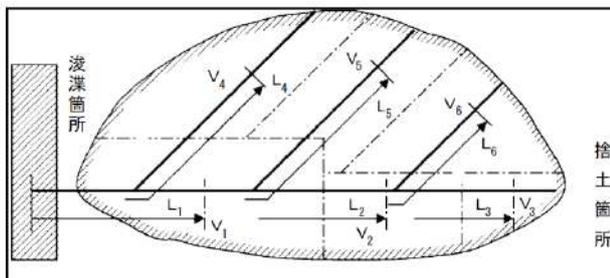
図4-2 排砂管設置計画図（湖沼浚渫等）
