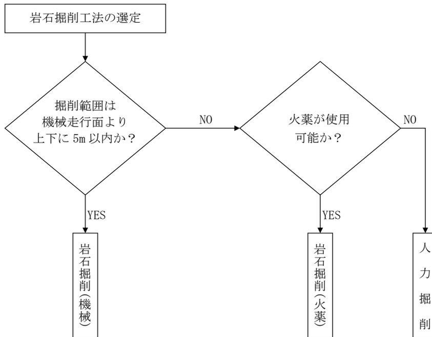
図 2-2 岩石掘削工法の選定
