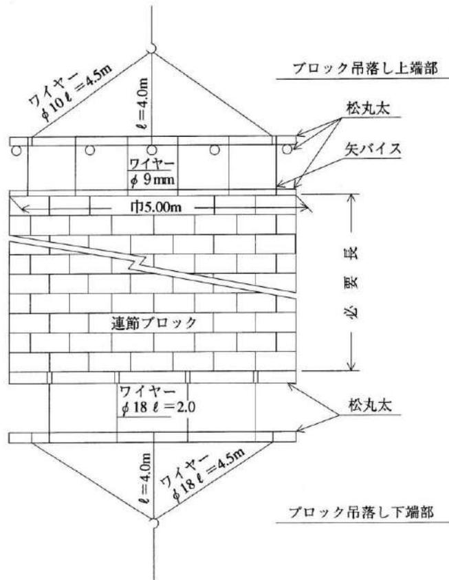
図 5-1 接続ブロック水中吊落し平面図
