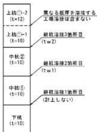
図 5-1 継杭溶接箇所(参考図)
