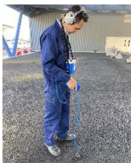
【漏水探知機による漏水探査】
