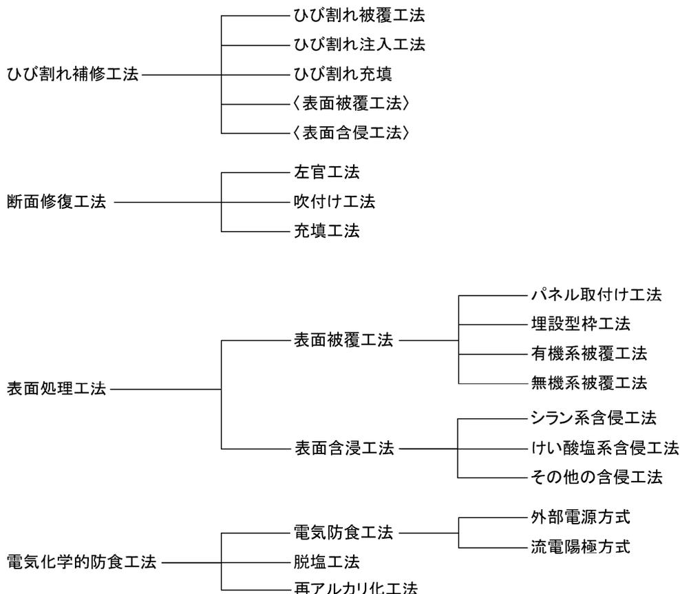
図 5.3.1 補修工法の分類一覧
