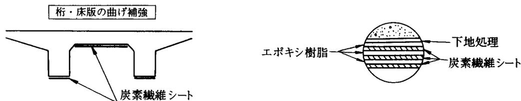
図 5.4.2 繊維補強工法概念図
