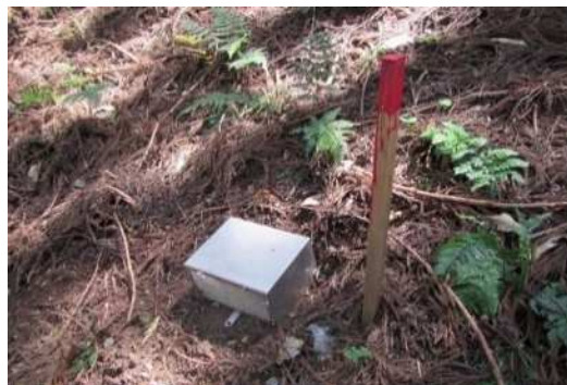
図-2 土砂受け箱の設置状況
