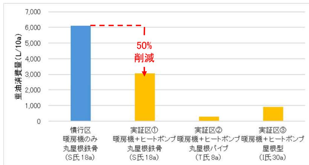
図8. ヒートポンプ利用時の重油の使用量比較 (2024年12月31日から2025年3月31日)
