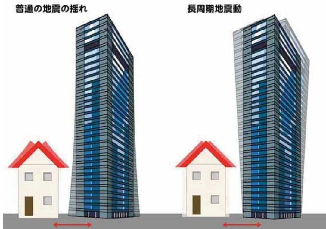
図1 通常の地震（左）と長周期地震動（右）による戸建て住宅と超高層ビルの揺れ方の違い。
