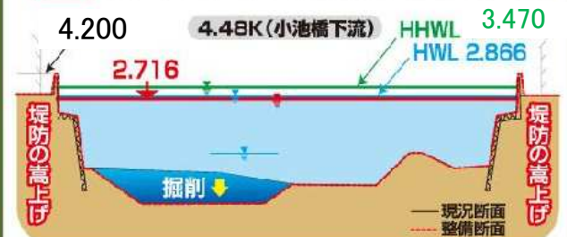
3 H20.8末豪雨に対して 地下河川整備+下流河道掘削後における河道水位
