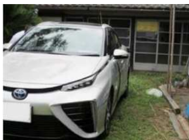
地域を巡回し、個人宅の照明や電子レンジ等に給電 (写真提供：トヨタ自動車株式会社)
