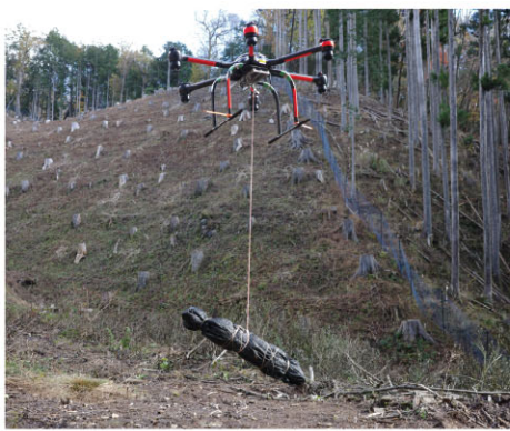
ドローンによる資材運搬(豊根村)
