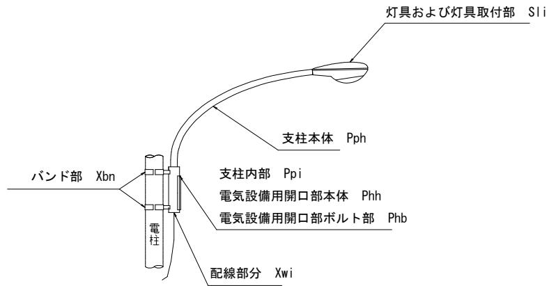
図-解 8-12 主な点検箇所（共架型）
