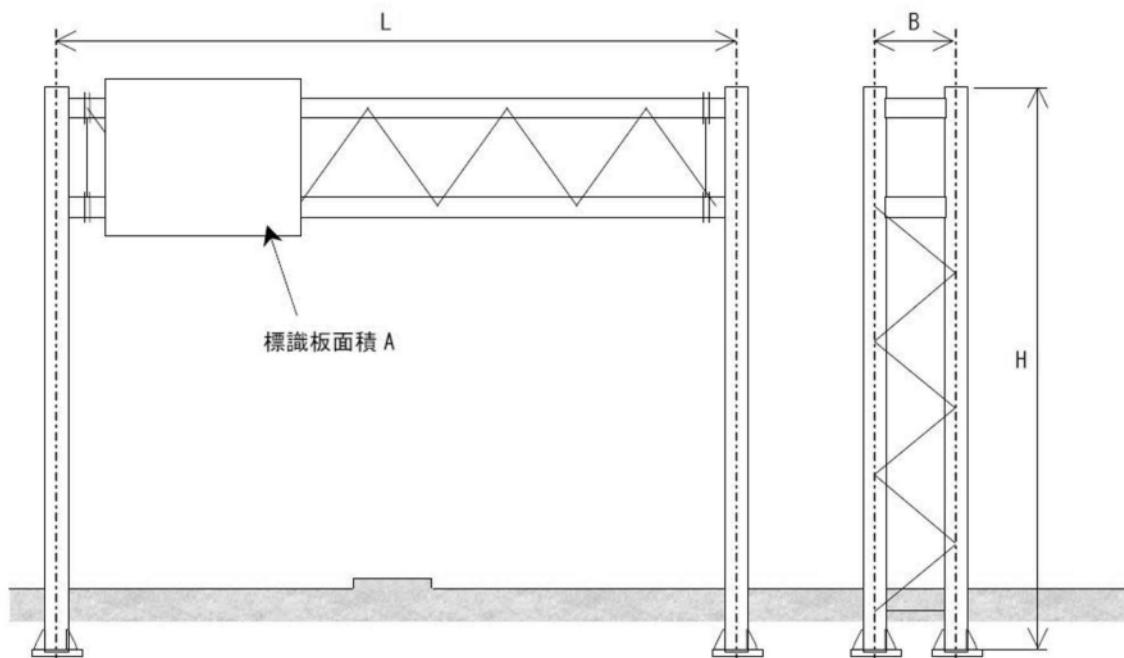
図-3.6 門型標識柱 (TYPE III) の寸法図
