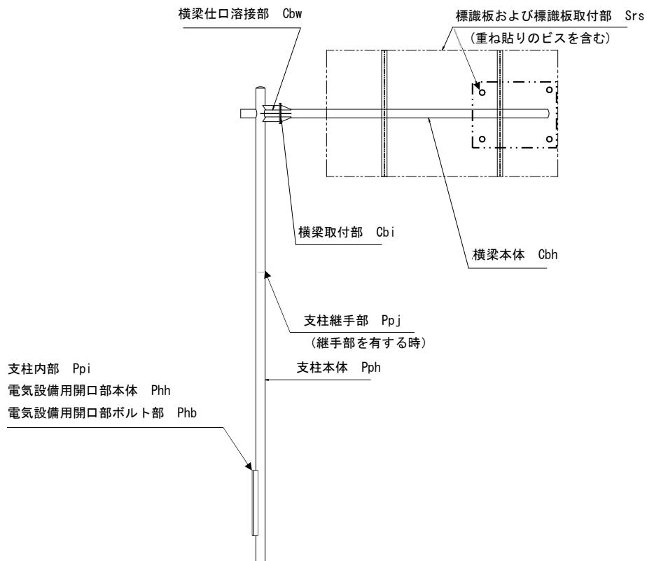
図-解 8-7 点検部位概略図 (逆L型)
