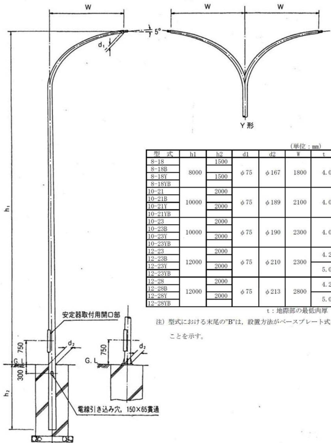
図-1 照明用テーパーpole (丸形長円形) 一般図 (単位 mm)
