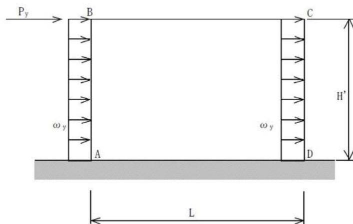
図-6.7 斜風時における荷重作用図
