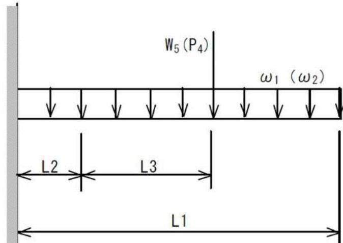
図-5. 2 梁の荷重作用図
