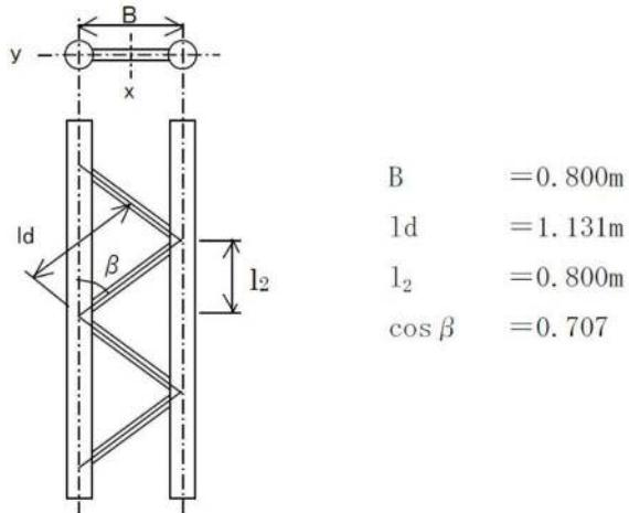
図-6.9 柱寸法図
