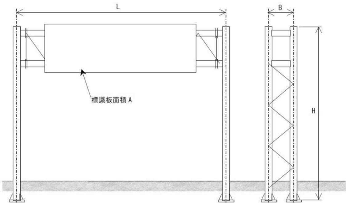
図-3. 4 門型標識柱 (TYPE I) の寸法図
