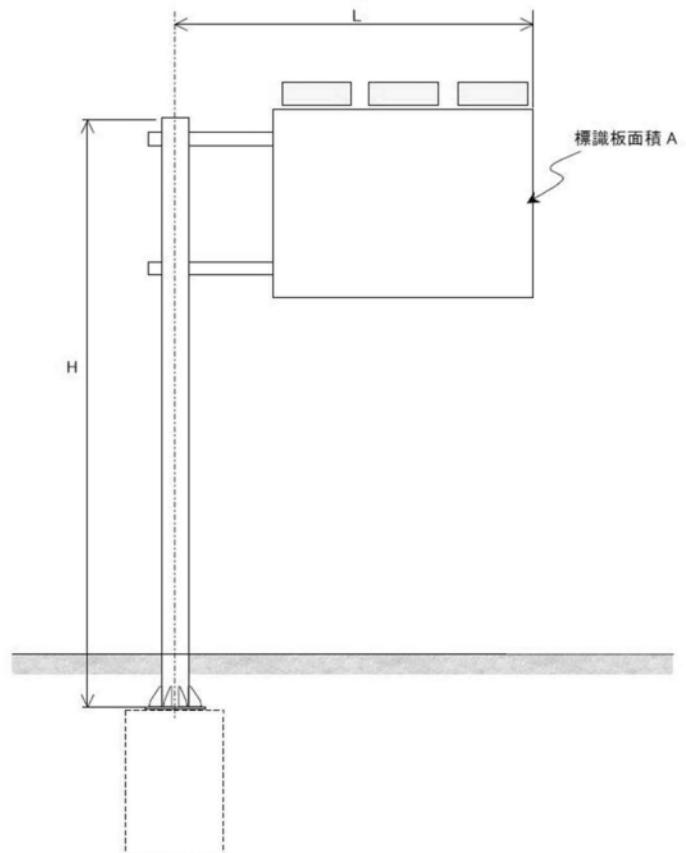
図-3. 1 F型標識柱の寸法図
