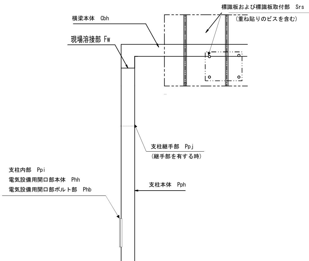
図-解 8-10 主な点検箇所（アーチ型門柱）
