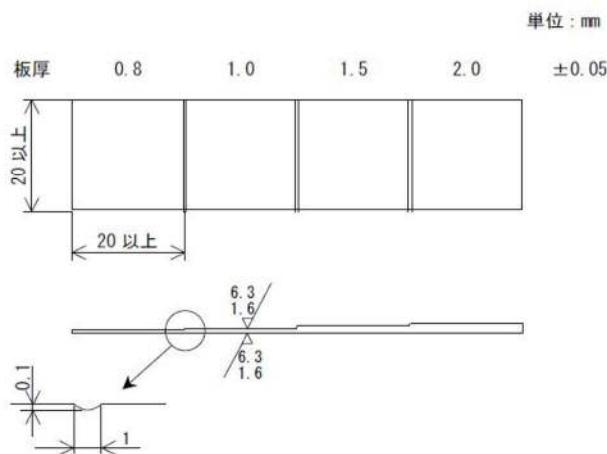
図-3 超音波厚さ計用の試験片の一例
