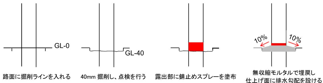
図-解 8-16 路面境界部の掘削・復旧方法
