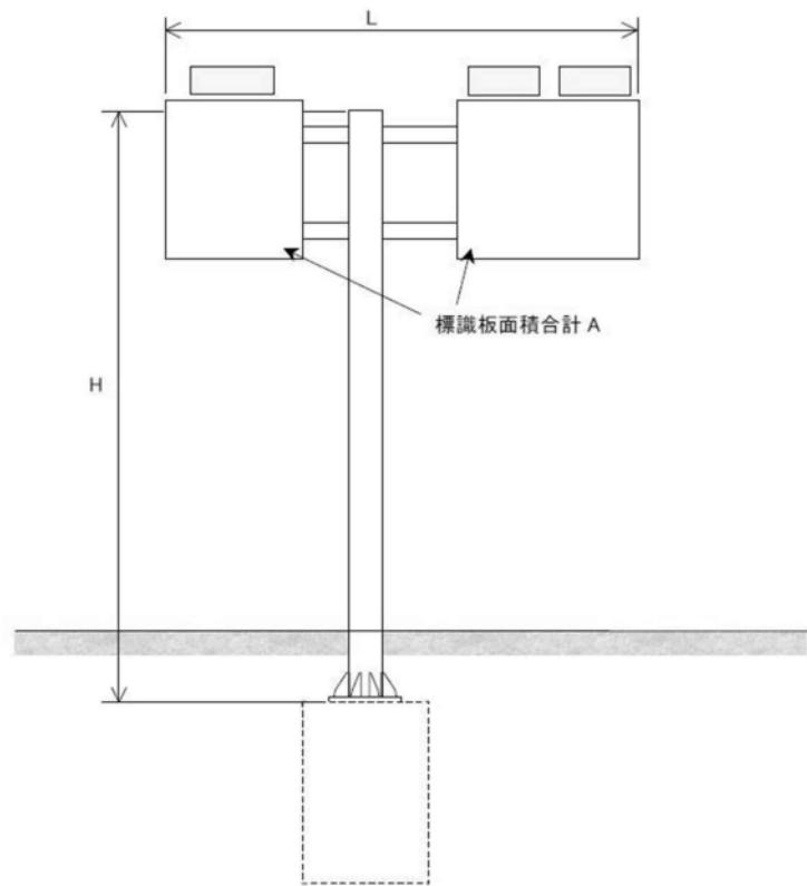
図-3. 3 T型標識柱の寸法図
