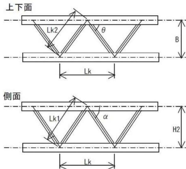
図-6.2 梁チス材の寸法図
