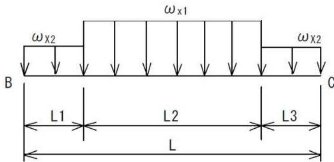
図-6. 4 梁の荷重作用状態（風時）
