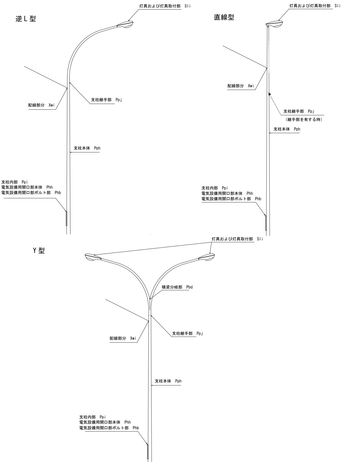
図-解 8-5 主な点検箇所（ポール照明方式）
