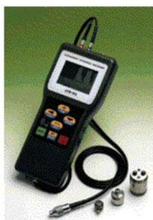
図-1 超音波厚さ計の一例
