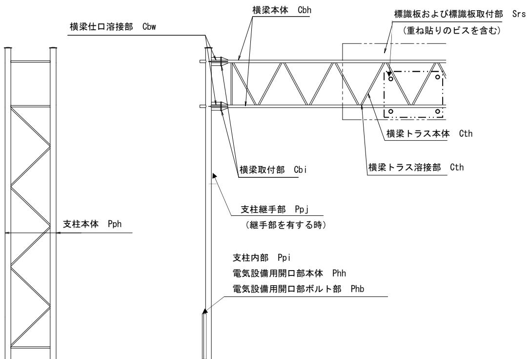
図-解 8-9 主な点検箇所 (ト拉斯型門柱)
