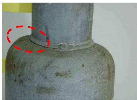
照明柱断面変化部の溶接に確認された亀裂
