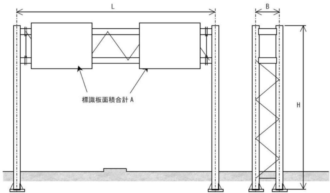
図-3.5 門型標識柱 (TYPE II) の寸法図
