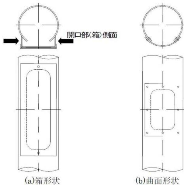
図-4 電気設備用開口部の形状
