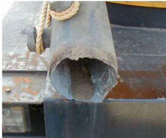
写真-2. 1 路面境界部の腐食が要因となった倒壊事例
