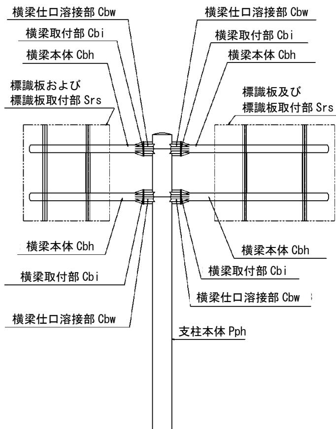
図-解 8-8 主な点検箇所 (T型)
