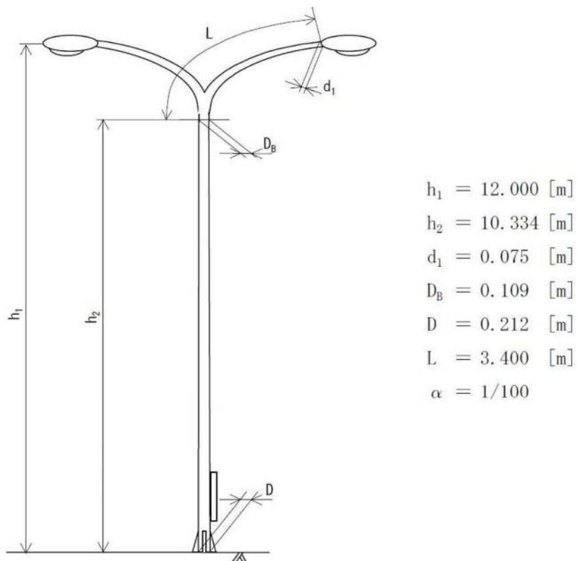
図-4. 1 照明ポールの形状寸法
