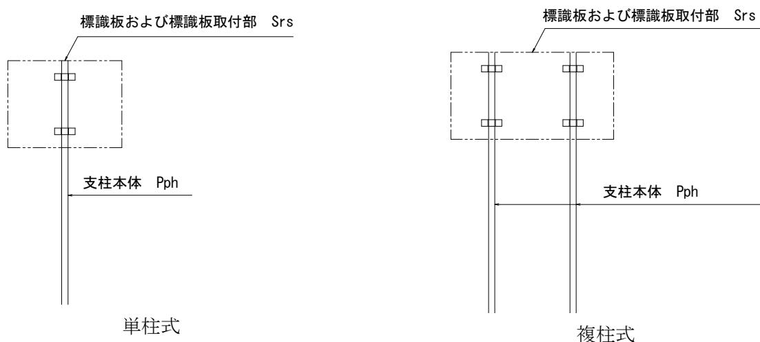
図-解 8-4 主な点検箇所（単柱及び複柱式）
