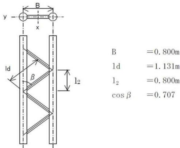
図-6. 8 柱寸法図
