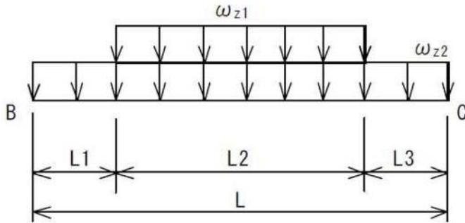
図-6. 3 梁の荷重作用状態（固定時）
