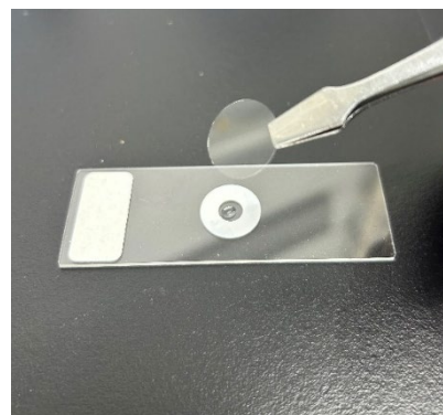
図 8 丸型カバーガラスによる封入
