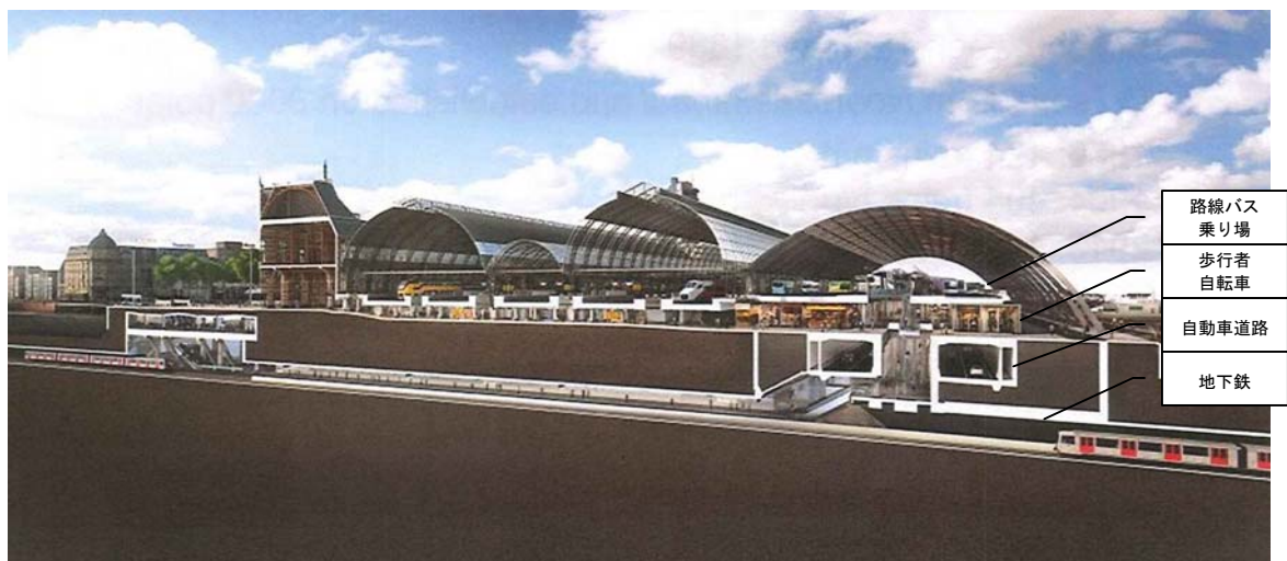
四層構造での整備パース図（各階層の説明は、調査団にて付記。）
