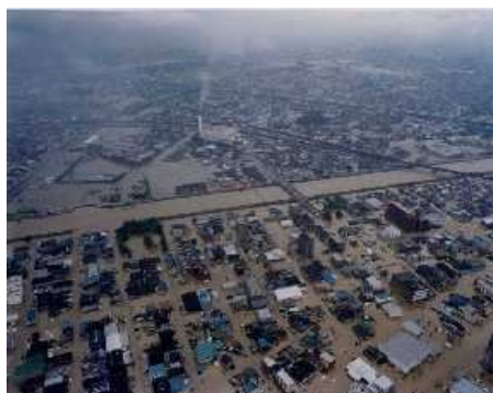
図表1-7 東海豪雨による堤防の決壊(新川破堤箇所 航空写真)
