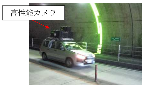
図表4-1-36 高性能カメラ搭載車によるトンネル点検
