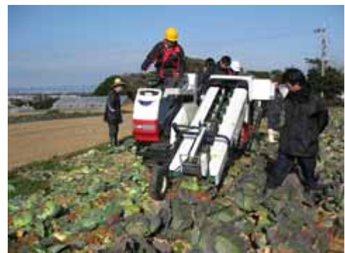
写真1 キャベツ収穫機による一斉収穫作業の様子
