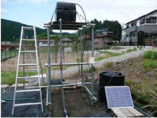
写真1 揚水式のソーラー灌水装置 「日射制御型拍動自動灌水装置」 (愛知県豊田市・山間農業研究所圃場)
