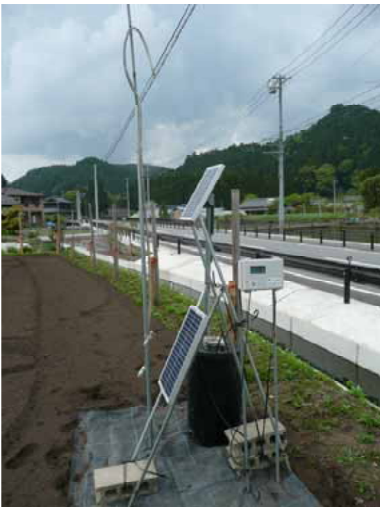
写真2 蓄電式のソーラー灌水装置 「ソーラーパルサーE」 (愛知県設楽町天狗なす圃場・H27年現地試験)
