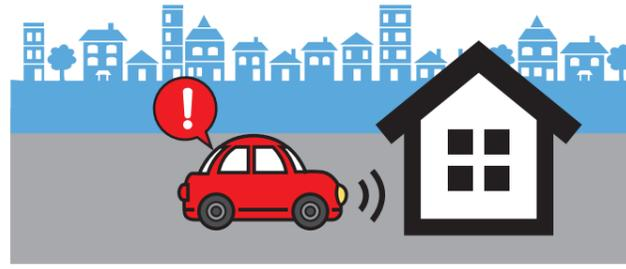
停止時や低速走行時に、車載のレーダー、カメラ、ソナーが前方や後方の壁や車両を検知している状態でアクセルを踏み込んだ場合には、エンジン出力を抑える等により、急加速を防止します。
