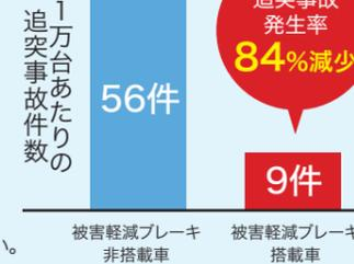
自動(被害軽減)ブレーキとペダル踏み間違い加速抑制システムで追突事故を
