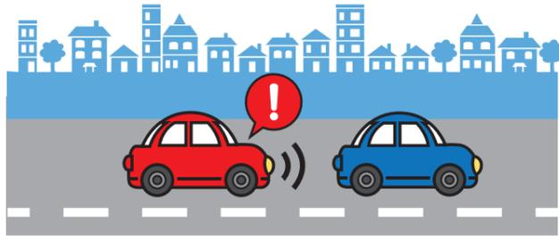
車載のレーダーやカメラにより前方の車両や歩行者を検知し、衝突の可能性が高い場合には、運転者に対して**警報**します。さらに衝突の可能性が高い場合には、自動でブレーキが作動します。
