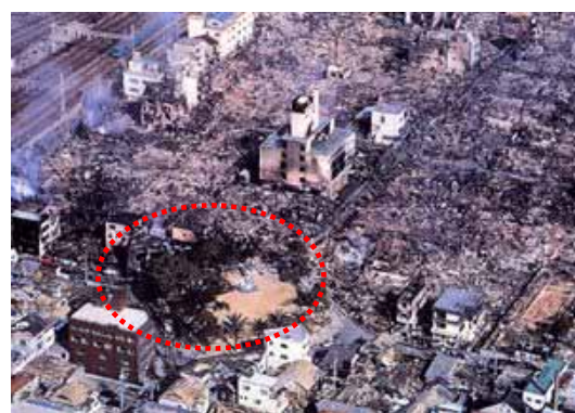
阪神・淡路大震災時に、緑が延焼を防止した。 ( 大國公園、兵庫県神戸市長田区 )
