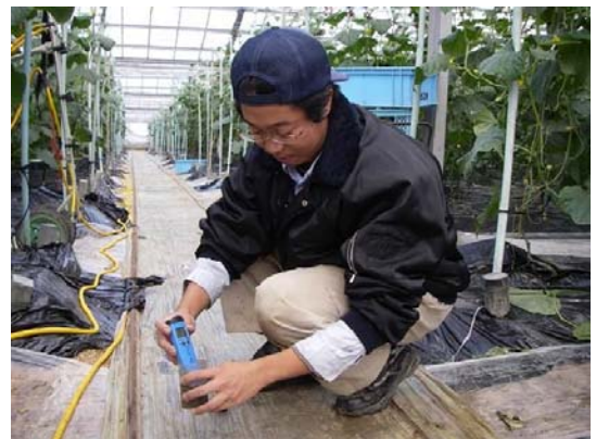
簡易 EC メーターによる土壌診断 (西尾市)
