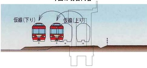
太田川方面(上り)の高架構造物築造のため、現在線(上下線)を仮線へ切り替えます。
