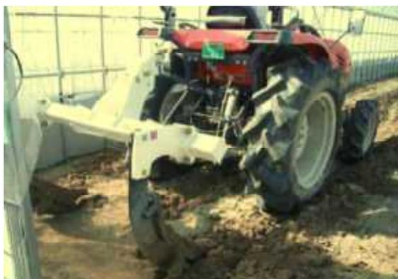
サブソイラを使って耕盤破壊
