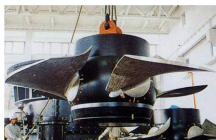
日光川河口排水機場 羽根車(口径 4,600mm)
