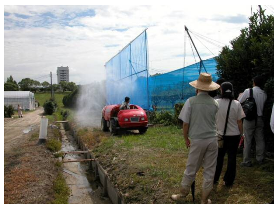
平成 18 年 ネット利用による農薬 飛散防止試験（場内）
