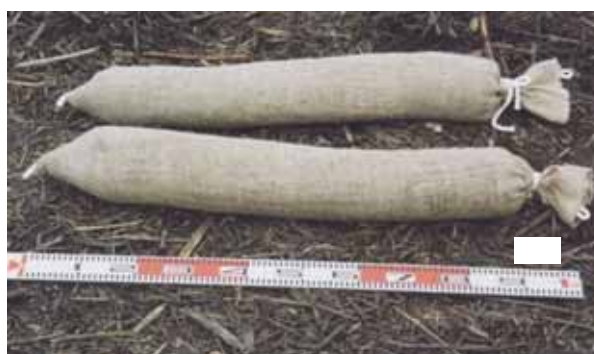
エコ法枠にウッドチップを詰めた状態
