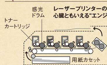
タンデムエンジンを搭載したレーザープリンターは、モノクロもカラーも印刷可能。
